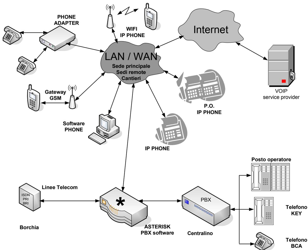
Il cuore dell'impianto è il centralino software Asterisk che viene installato tra il preesistente centralino tradizionale e le linee telefoniche dell'operatore di telecomunicazioni.
